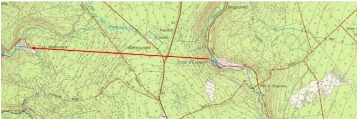
*Sur la carte ci-dessus, le trait rouge figure le tunnel allant du petit barrage de la Soor vers le Trou Malbrouck. Ce canal souterrain alimente le lac de la Gileppe dont l'extrémité d'un bras pointe au bord gauche de la carte.*
