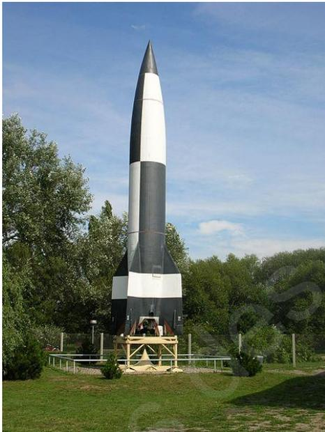
*Modèle d'une fusée supersonique V2 au musée de Peenemünde dans le nord de l'Allemagne. Le quadrillage noir/blanc permettait d'étudier les mouvements de la fusée au cours des essais.*
